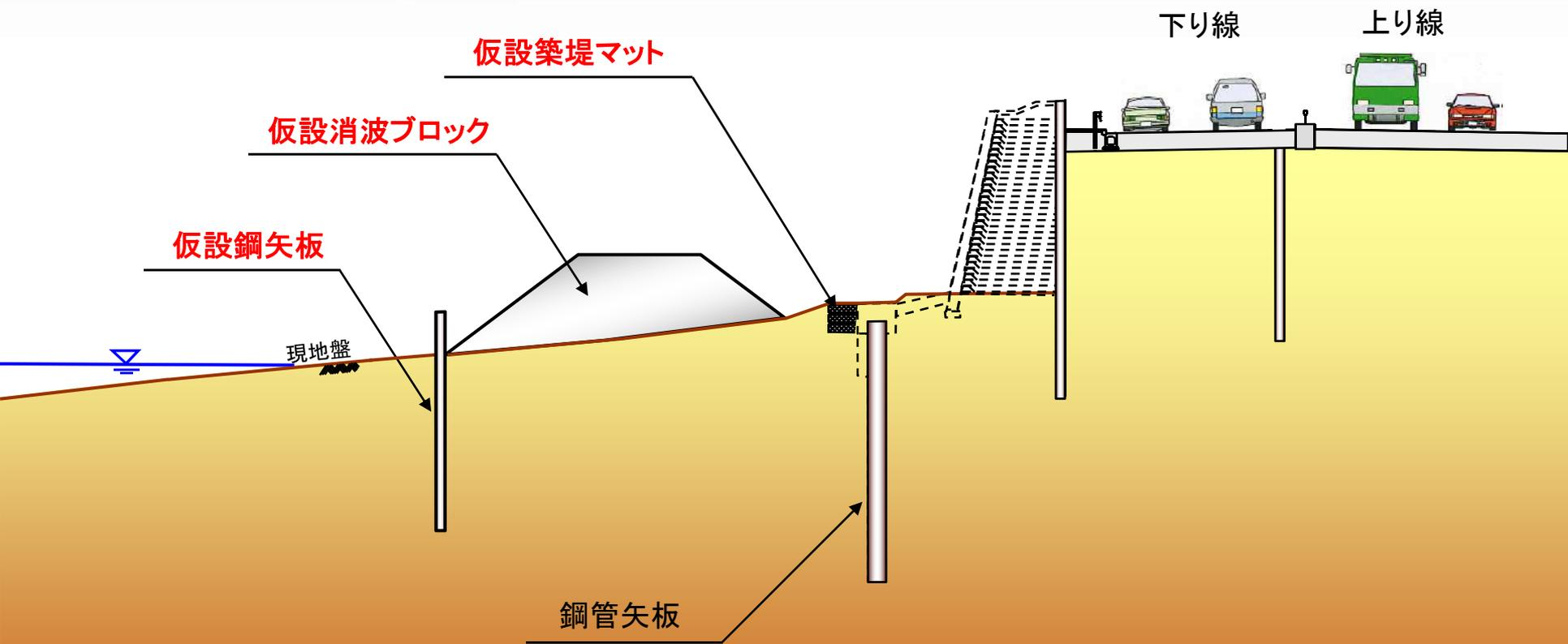
鋼管矢板の施工完了までの、海からの波浪対策として仮設します。
