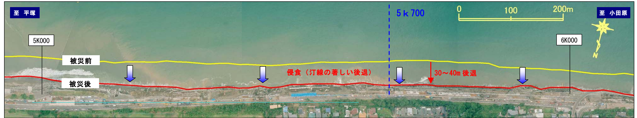
図7.1 被災前と被災後の汀線位置の比較
