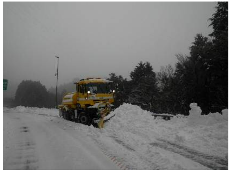
除雪作業 (国道1号箱根新道)
