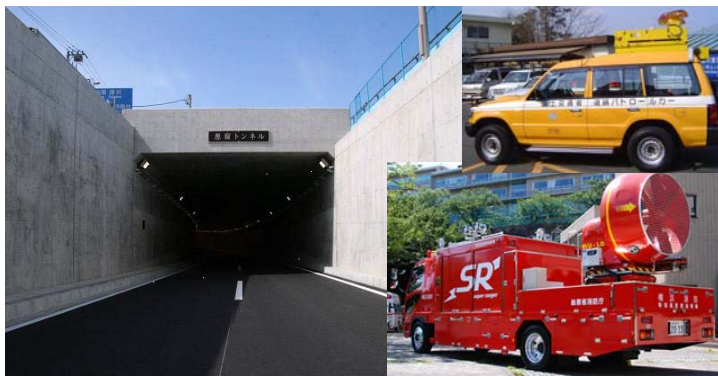
排煙訓練で使用する大型ブローア車
