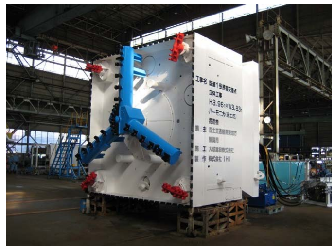
シールドマシン 幅4m×高さ4m
