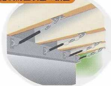
落橋防止装置の設置
