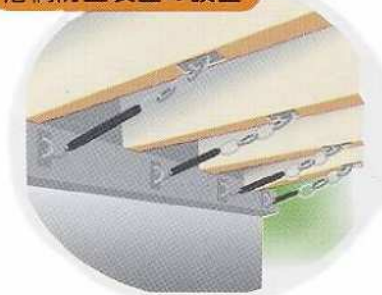
落橋防止装置の設置
