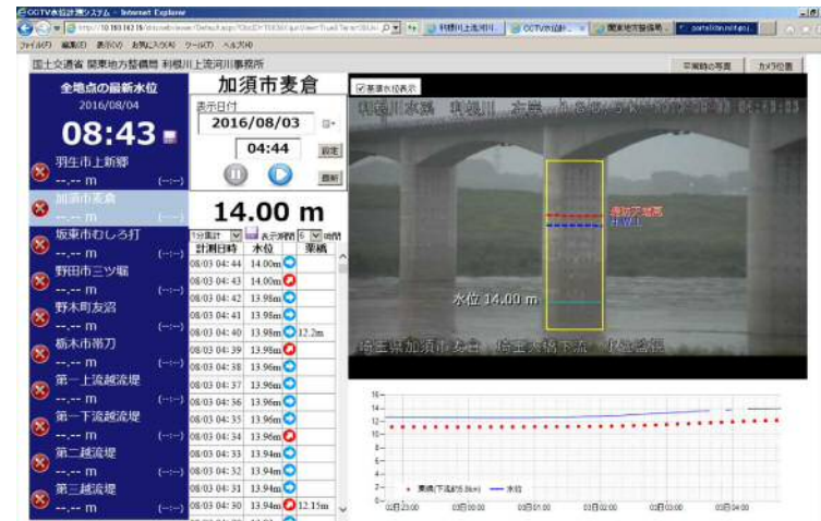
◀ CCTV 水位計測 システム
