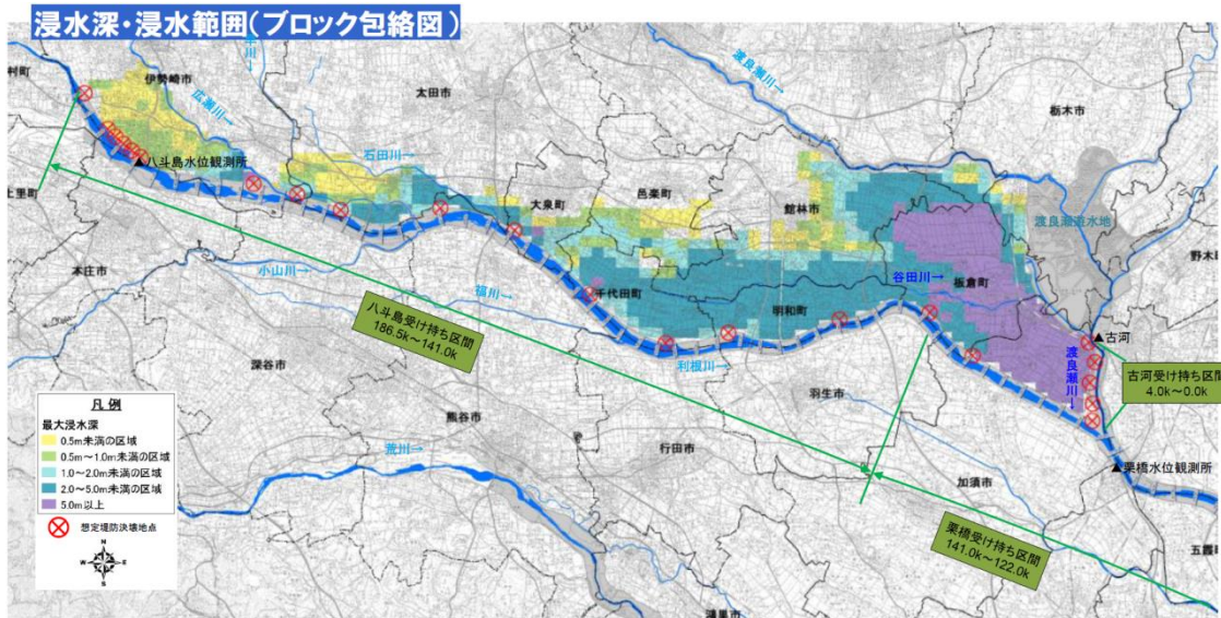
図3 浸水深・浸水範囲(利根川上流左岸ブロック包絡図)
