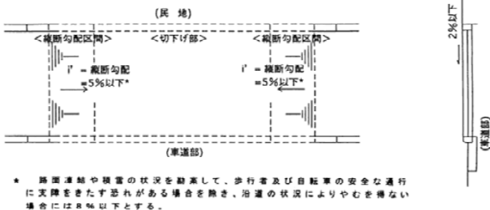
参考図 II-3 歩道等の全面切下げを行う構造
