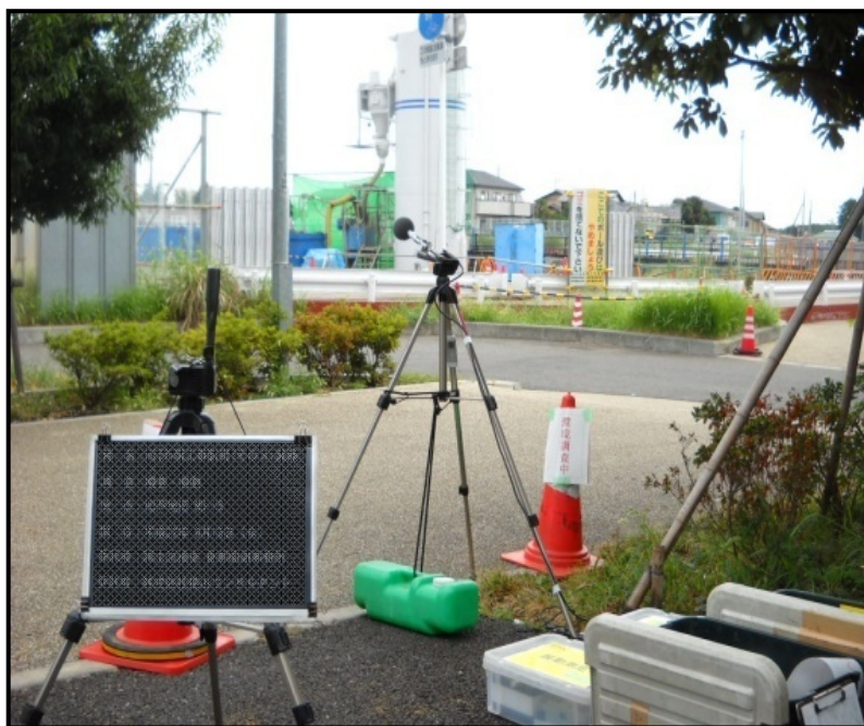
工事中の騒音測定の様子
