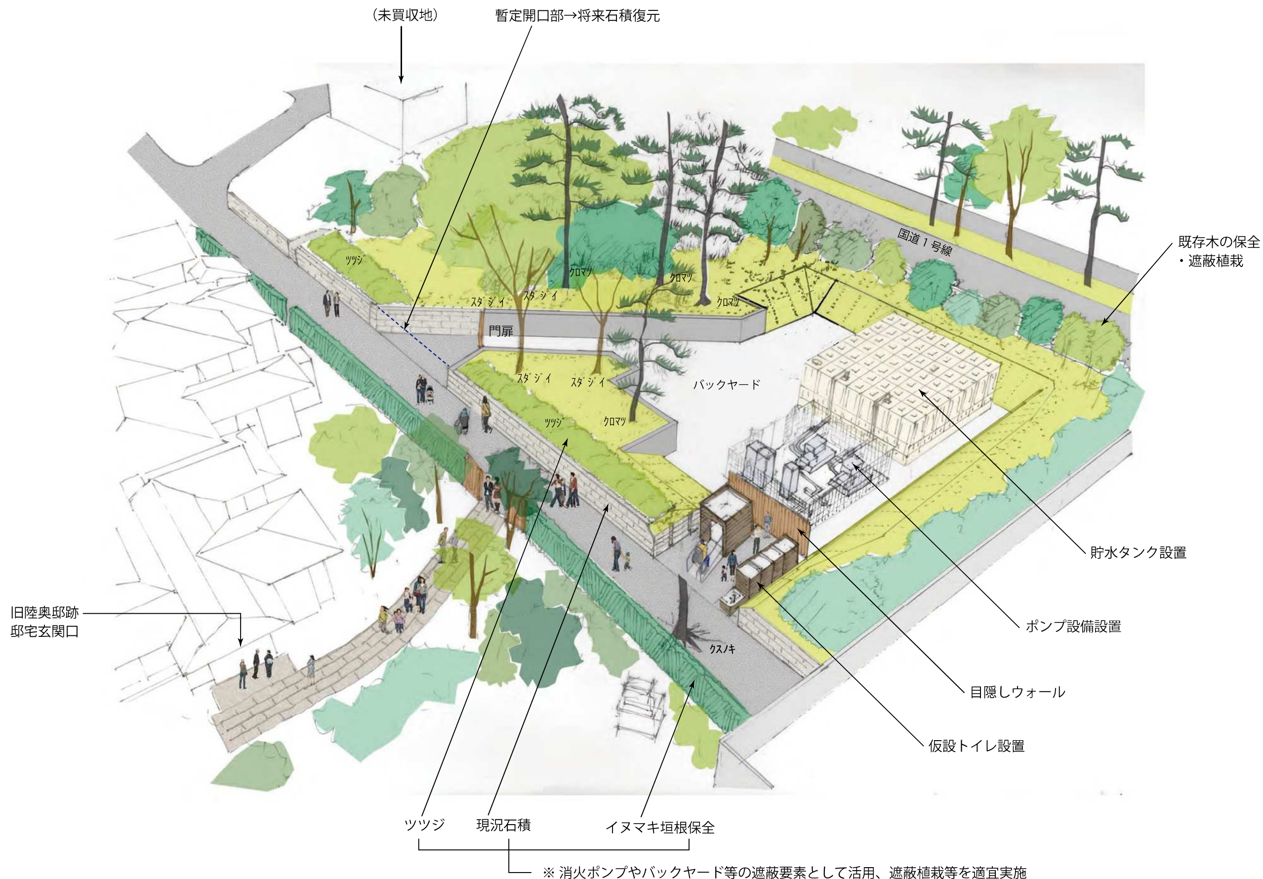
明治記念大磯邸園 / 消火ポンプ場 + バックヤード設置及び仮設トイレの設置について
