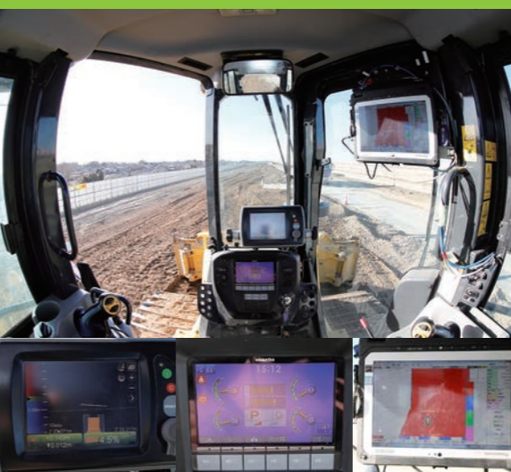
複数のモニターが設置されたICT仕様の建設機械の操縦席
