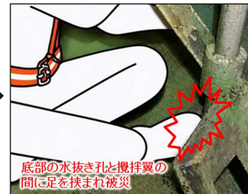
③右足が排水孔に挟まり、負傷
