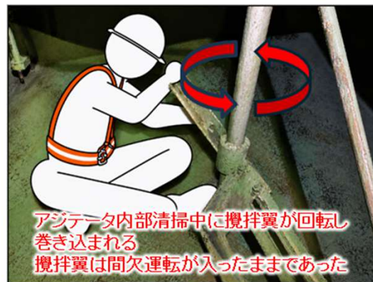
②内部で作業中、攪拌機が作動 作業員は攪拌機にしがみつ
