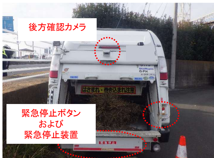
運転者による後方確認カメラ・注意喚起用スピーカー・緊急停止ボタン・緊急停止装置搭載のパッカー車を使用
