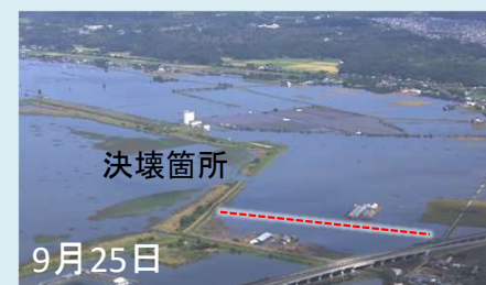
追加の工事用道路 決壊箇所 浸水の解消
