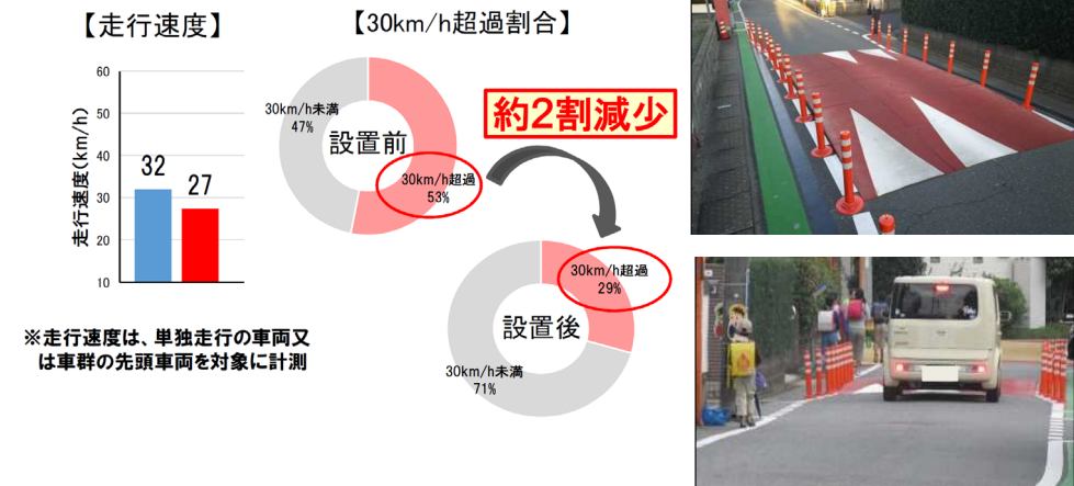
▲可搬型ハンプ設置区間の効果検証事例
