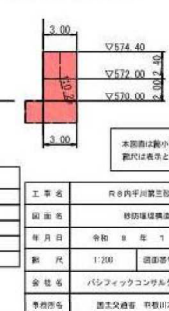
左岸側非越流部(重方式)
