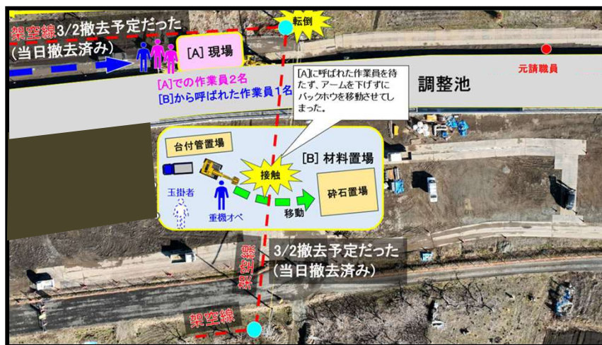
事故発生時の現場状況 (重機移動動線：緑点線 架空線：赤点線)
