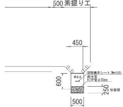
水道管設置標準断面図 S=1:30
