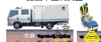
路面下空洞調査
