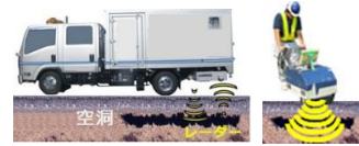
路面下空洞調査
