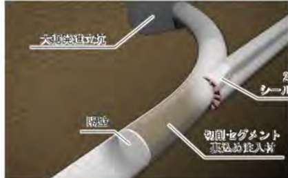
直接切削の施工(イメージ)
