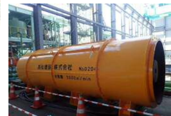
④大型ファン (風量3,000m³/min)
