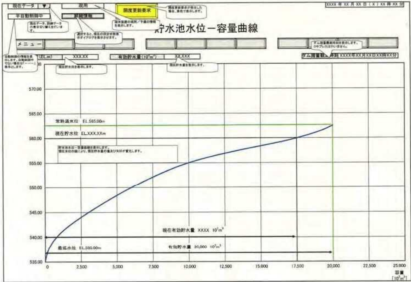
図 16 貯水池水位—容量曲線【例】
