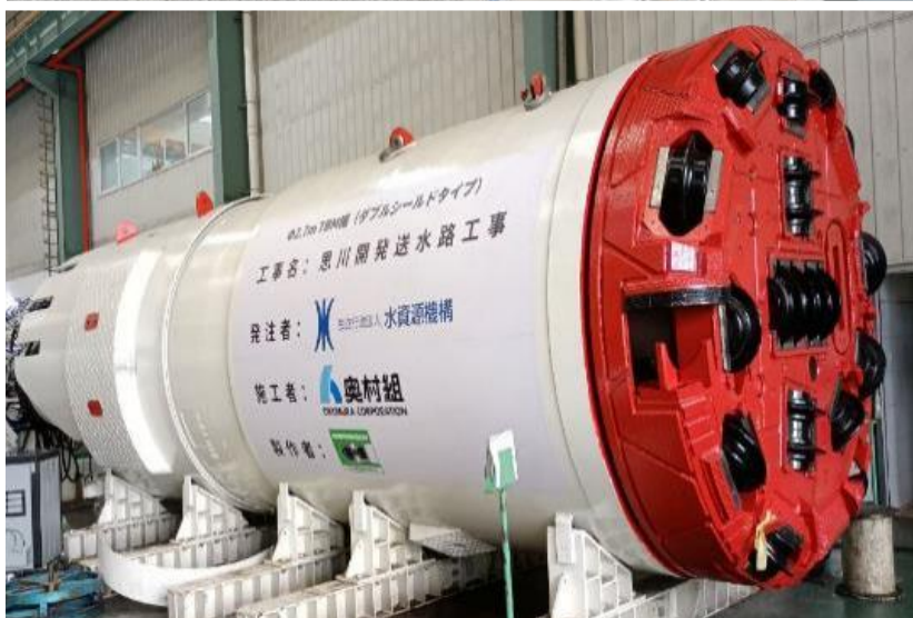
TBM(トンネルボーリングマシン)
