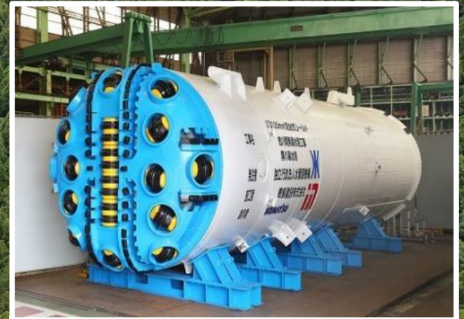
黒川導水路シールドマシン
