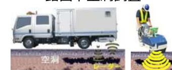
路面下空洞調査
