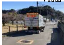
(空洞探査車による調査)
