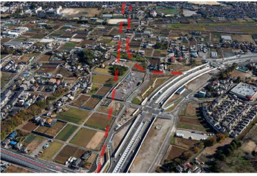
外環道との接続箇所では、最大土被り約18mのトンネル工事を予定
