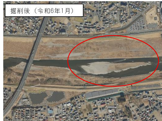
写真 6-3 中州を掘削することで水衝部対策を行った箇所（北関東道下流）
