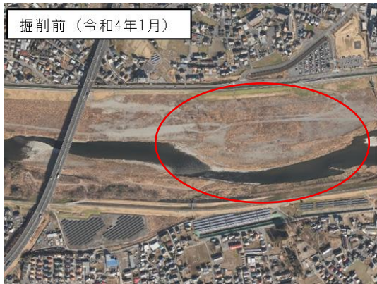
写真 6-3 中州を掘削することで水衝部対策を行った箇所（北関東道下流）
