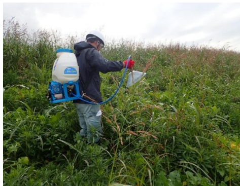
写真 6-8 植物成長調整剤・除草剤を用いた現地実験
