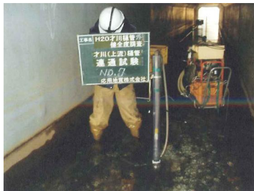
写真 6-20 樋管の連通試験
