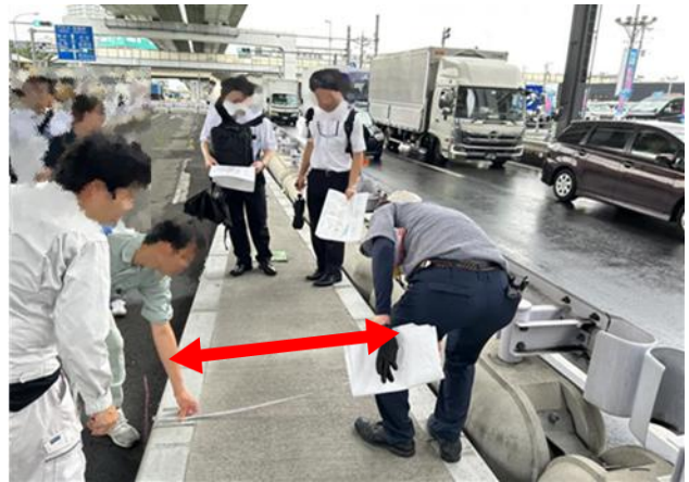
写真2 現地実査 (中央分離帯幅計測)
