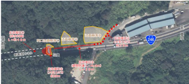
写真-2 応急復旧工事の概要
