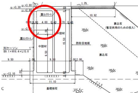
図-3 重力式(スリットケーソン)の断面図
