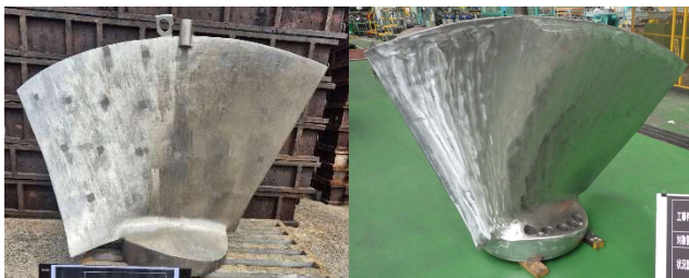
図-2 羽根車ハネ（実機ポンプ）の写真（左：鋳造完成時、右：機械加工完了時）
