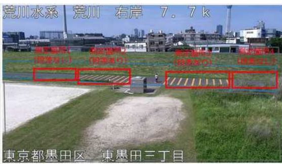
写真-8 自転車速度検知エリア
