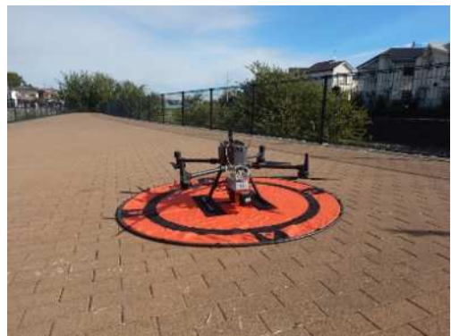
写真-4 UAV 測量実施状況
