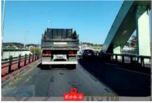
写真 6. 車載カメラによるポットホールを検知
