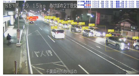
写真5. CCTV カメラの映像から車両の走行状況を解析
