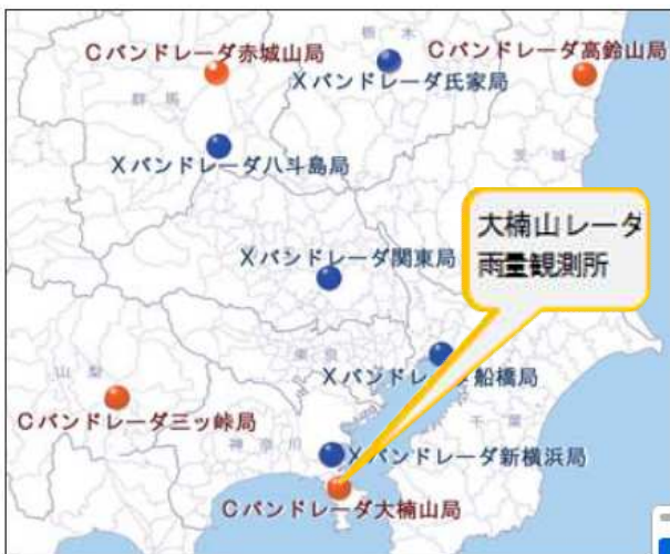
▲関東地方整備局管内のレーダ雨（雪）量計設置状況図
