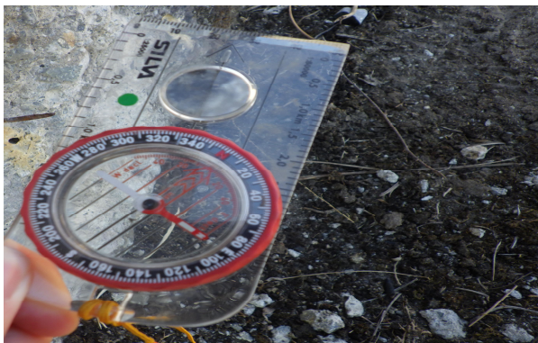
写真-4 方位磁石を用いての磁場の確認
