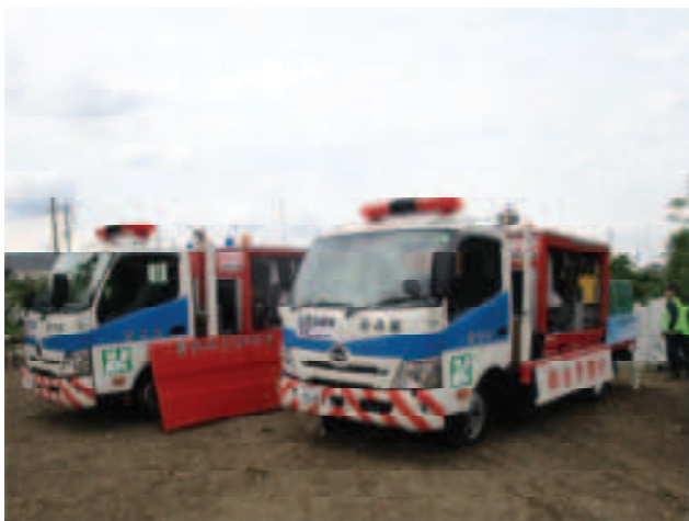
【栃木県排水ポンプ車全景】
