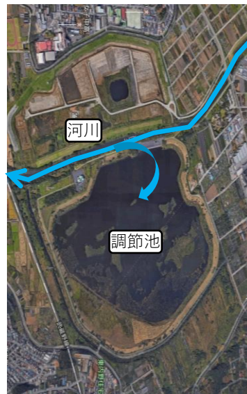
河川の増水時に調節池へ排水
