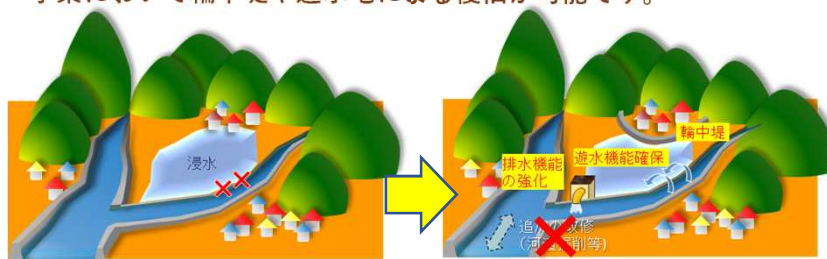
低い堤防が越水・決壊し浸水
