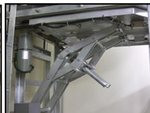
換気口浸水防止機
