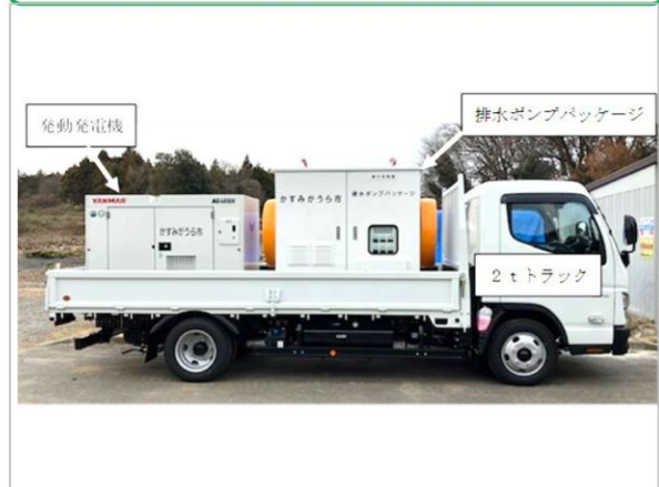
「移動式排水ポンプ車」
