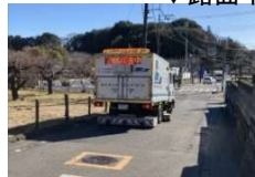
(空洞探査車による調査)
