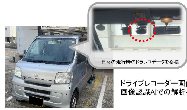
<掲載技術名>社会インフラ設備の台帳整備・劣化診断サービス“Audin AI” (検出項目:ポットホール、区画線の摩耗)
