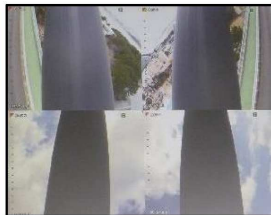
撮影画像 4台のビデオカメラで斜材の全周を撮影
