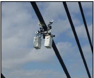
撮影画像 4台のビデオカメラで斜材の全周を撮影
