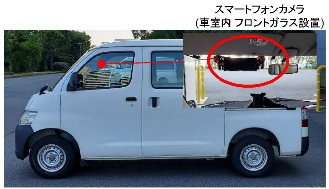
<掲載技術名>スマートフォン路面モニタリングシステム (検出項目:ひび割れ率、わだち掘れ量、IRI)
