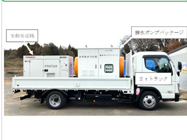
「移動式排水ポンプ車」
