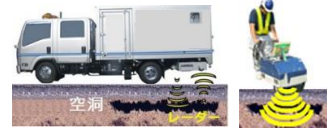
路面下空洞調査
