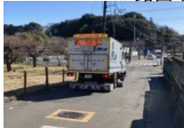
(空洞探査車による調査)
