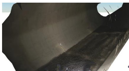
図 1 SfM により復元されたトンネル内 3 次元点群モデル
