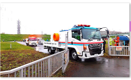
荒川下流河川事務所の排水ポンプ車が到着・配置
