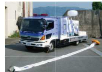
排水ポンプ車(1台)
