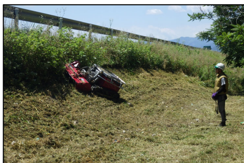
急勾配法面は遠隔操縦で除草しています
